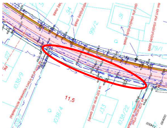
Obr. 6 – Chybějící zpevnění krajnice v km 11,479 – km 11,539
