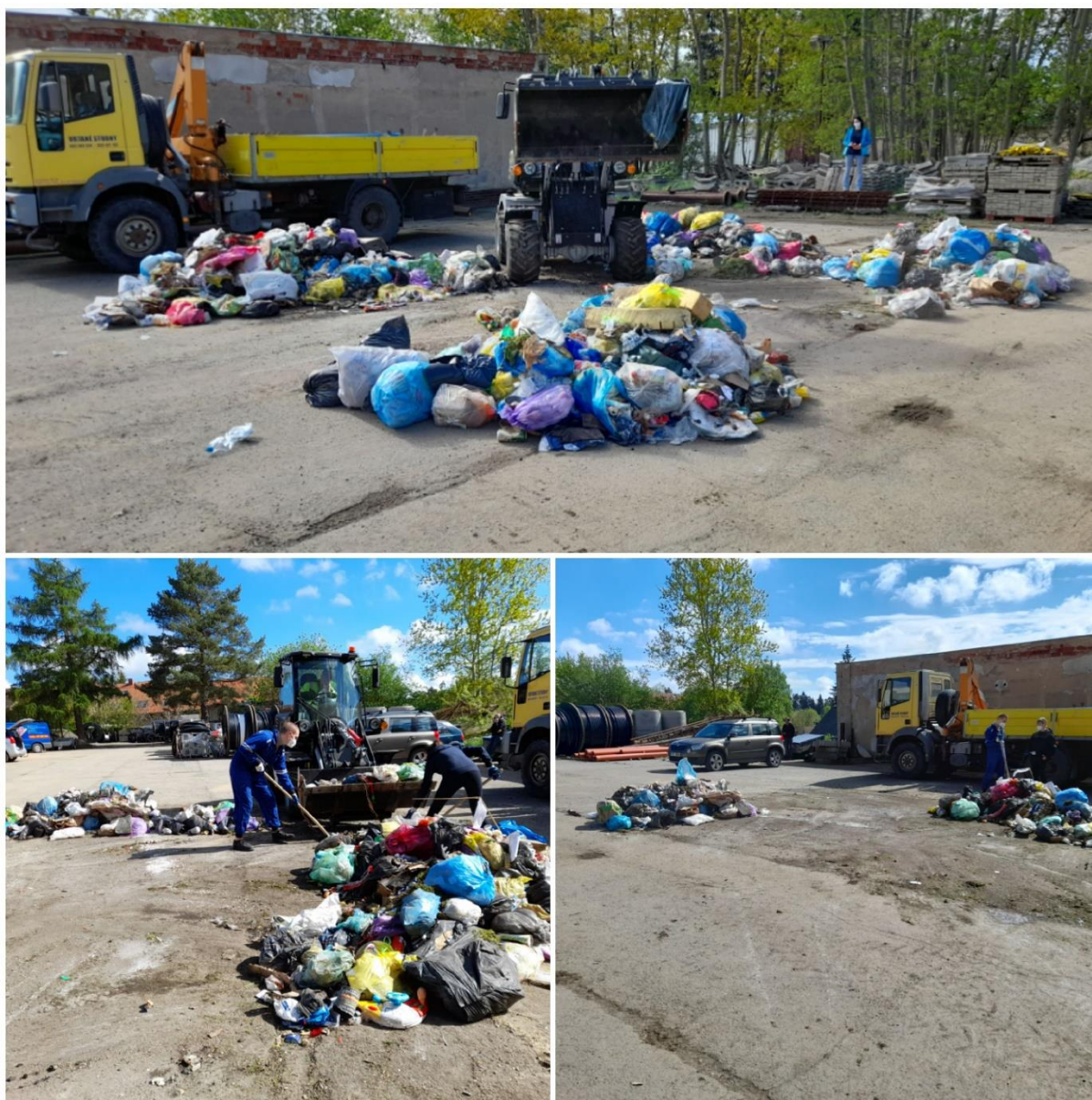
Obrázek 1: Snižování hmotnosti základního vzorku kvartací
