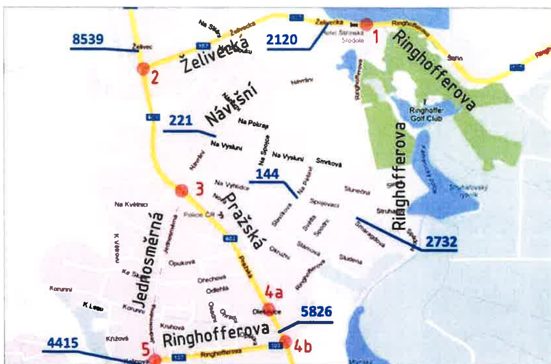
Obr. 45 Znáromění sčítacích stanišť v katastru Kamenice (červeně) a přehled průměrných denních intenzit ve voz/den zjištěných ze statistického radaru Sierzega SR4 (modře)
